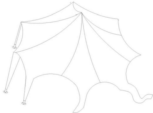
3. Установите остальные ножки. Далее установите пяты и зафиксируйте с помощью болтов. С помощью застёжек закрепите полотно крыши на ножках.
